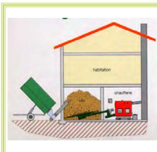
Silo avec vis de remplissage
